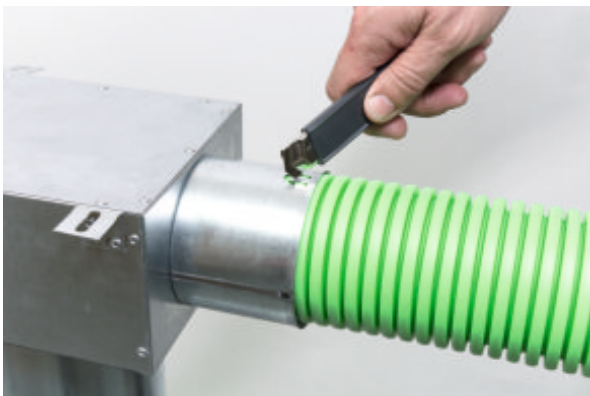
5) Premere entrambe le serrature per impedire al tubo di scivolare fuori.
